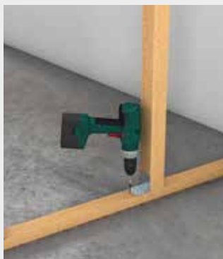
Montaža lesene podkonstrukcije s pomočjo žebeljev ali jeklenih kotnikov
