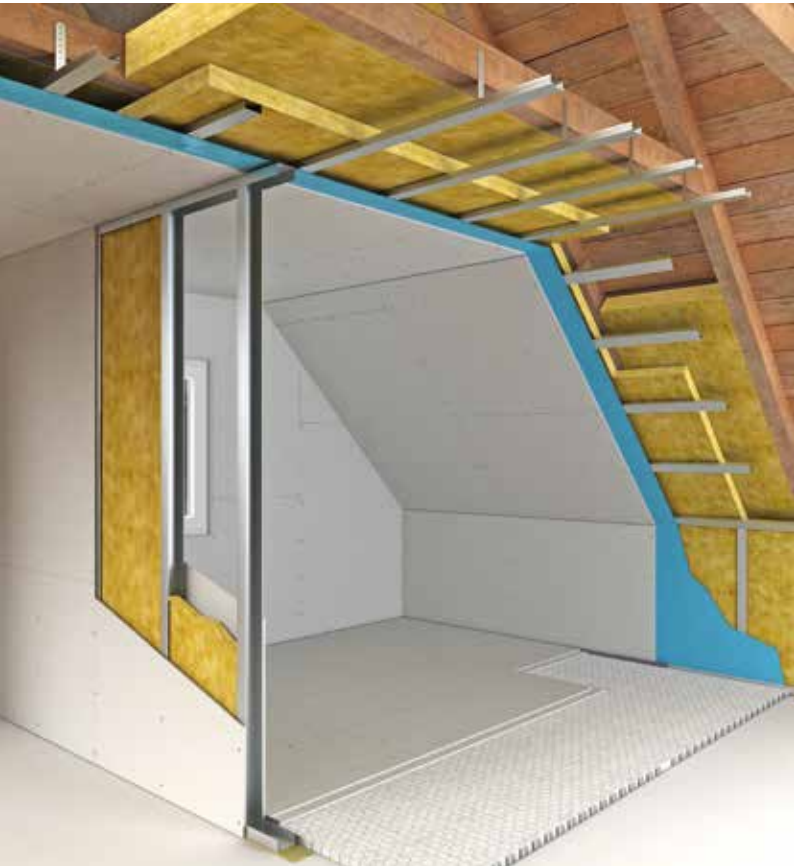
Oсни razmaki na podkonstrukciji pri stropih in poševninah
