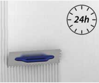
nanos drugega sloja ometa v debelini 2–3mm fermacell™ HD lahke malte po strjevanju predhodnega armirnega sloja
