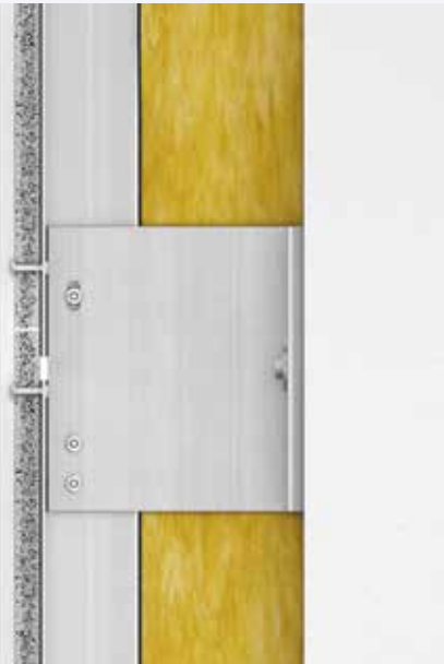
Varianta 3: Stik profilov zakrit s pritrdilom na stensko držalo
