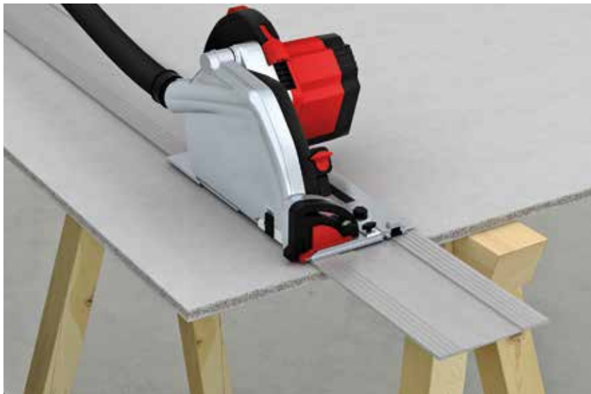
fermacell® Powerpanel H 2 O plošče režemo s pomočjo ročne krožne žage z vodilom reza.
